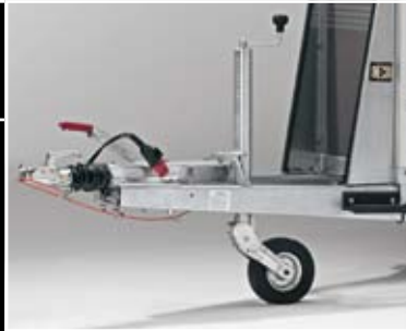
Automatikstützrad mittig montiert
