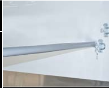
Durchgehende Bruststange für Fohlentransport
