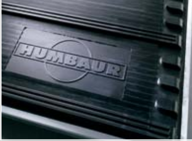
Gummimatte auf Heckklappe mit Trittschutz und seitlichem Wegrutschstopp
