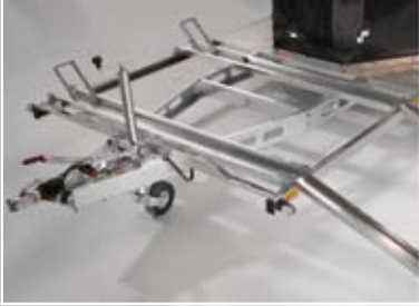
Verlängerte Zugdeichsel für den Kutschentransport
