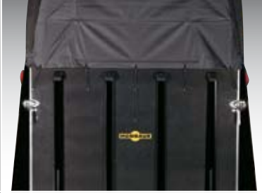
Massive Heckabstützungen und Scharniere – feuerverzinkt und pulverbeschichtet
