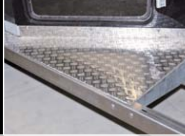
Beidseitig Tritte aus Aluminium-Riffelblech
