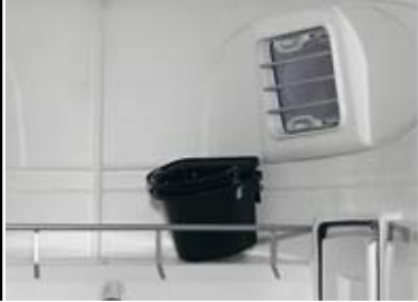
Tauchbad feuerverzinkte Reling auf Sattelkammer und zwei abnehmbare Futtertröge
