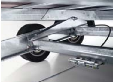
Brücke mit speziellem Kipplager direkt mit den beiden Achskörpern verbunden
