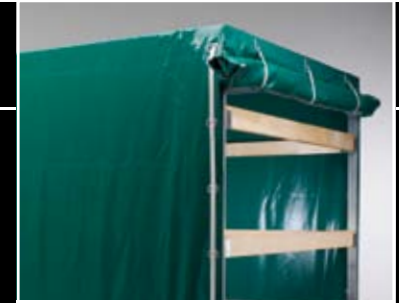
Plane & Spriegel, Ladehöhe 1600 mm, 1800 mm und 2000 mm
