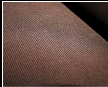
Ladefläche durchgehend mit Siebdruckplatte geschlossen
