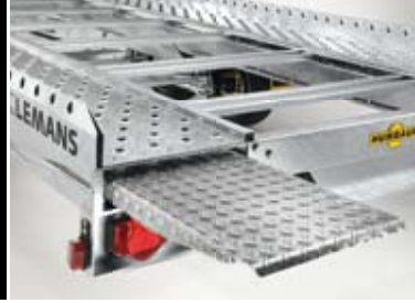
Im Bohlen-schacht verstaute Aluriffelblech-bohlen
