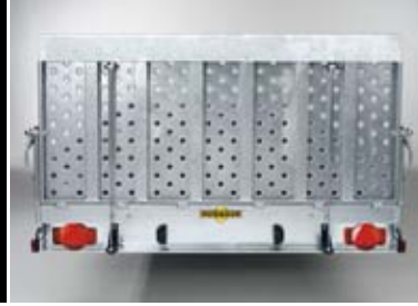
Gelochte Überfahrwand hochgeklappt mit Gasfederunterstützung
