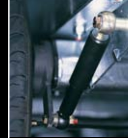
Radstoßdämpfer (für 100 km/h Zulassung)
