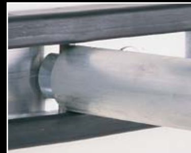
Sperrstangen für Stäbchenzurrschiene
